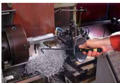
Včetně škrabky na třísky pro odstraňování malých třísek
