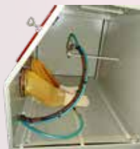
PAL Innenraum (Injektorsystem)
