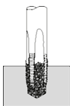
Obrábění slepých otvorů závitníkem s přímými drážkami u krátkotřískových materiálů
